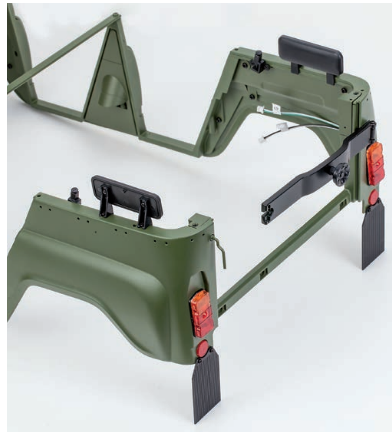
Кузов модели с установленным откидным кронштейном запасного колеса
